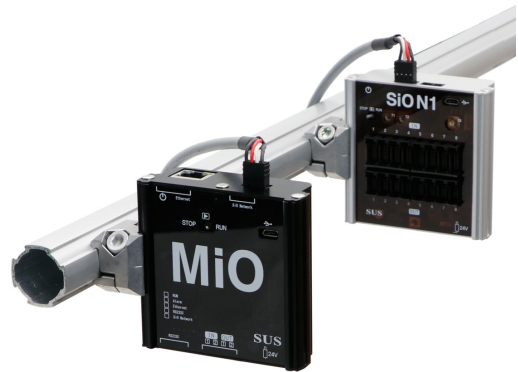
MiO(左)と SiO-N1(右)。コントローラ同士の接続は専用ケーブルで簡単に行えます。
