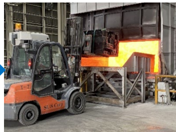
自社鑄造炉にて溶解・鑄造
