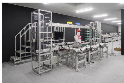
多品種少量生産に対応する搬送システム
