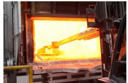
自社工場の鋳造炉にて溶解・再生
